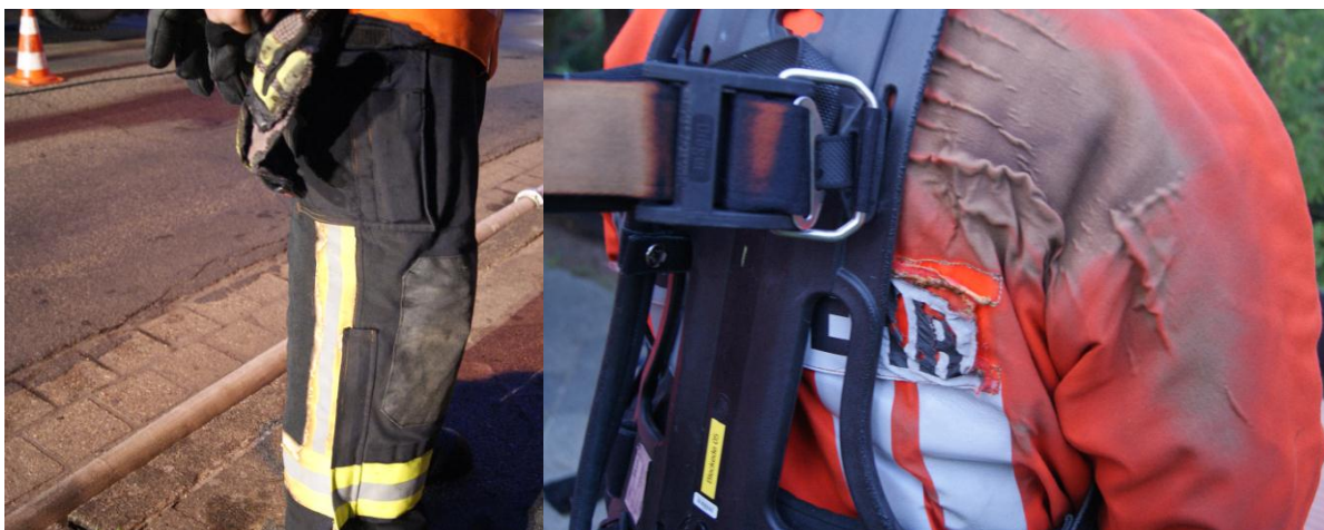
Bild 3 und 4: Deutlich sind die Verfärbungen an den Reflexstreifen der Atemschutz-Überhose erkennbar. Die TH-Handschuhe in den Beintaschen sind geschrumpft! Die Überjacke Modell „Niedersachsen“ weist deutliche Verfärbungen und Verhärtungen auf. Das Atemschutzgerät musste ausgesondert werden.
